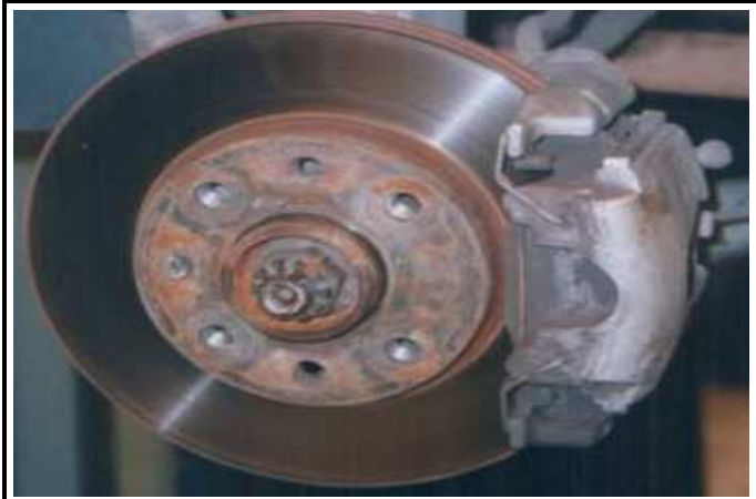
J3-1) Freno completo desarmado Complete brake assembly
